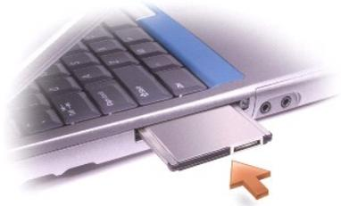
Der Computer erkennt die meisten PC-Karten und lädt automatisch den entsprechenden Gerätetreiber. Wenn Sie vom Konfigurationsprogramm zum Laden der Hersteller Treiber aufgefordert werden, können Sie dafür die mitgelieferte Diskette oder CD verwenden.
