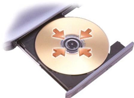
5. Schieben Sie die Laufwerkschublade zurück in das Laufwerk.
